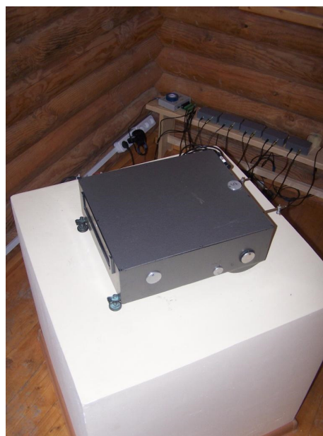
Рис.2. Магнитовариационная станция (МВС) на постаменте внутри вариационного павильона. На дальнем плане у стены электроника, обслуживающая МВС и метеодатчики.
